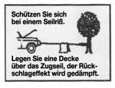
Wenn Sie eine schwere Last ziehen, legen Sie eine schwere Decke oder Jacke ca . 1,5 m vom Lasthaken entfernt über das Zugseil. Dies dämpft im Falle, dass das Seil reißt, den Rückschlageffekt.
