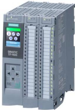
SIMATIC S7-1500 Kompakt-CPU CPU 1511C-1 PN, Zentralbaugruppe mit Arbeitsspeicher 175 KB für Programm und 1MByte für Daten, 16 digitale Eingänge, 16 digitale Ausgänge, 5 analoge Eingänge, 2 analoge Ausgänge, 6 schnelle Zähler, 4 schnelle Ausgänge für PTO/PWM/Frequenzausgabe 1. Schnittstelle: PROFINET IRT mit 2 Port Switch, 60 ns Bit-Performance, inkl. Frontstecker Push-In, SIMATIC Memory Card notwendig
