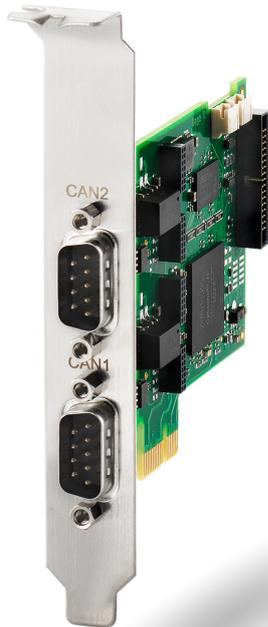
Die Ixxat CAN-IB200/PCIe ist eine aktive PCI Express-Schnittstellenkarte mit zwei CAN-Kanälen und galvanischer Trennung. Sie stellt eine einfache und kostengünstige Möglichkeit dar, Computer an ein CAN-Bus-Netzwerk anzuschließen.
