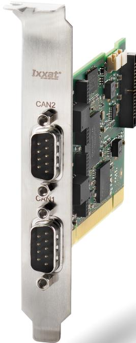
Die Ixxat CAN-IB400/PCI ist eine aktive PCI Schnittstellenkarte mit zwei CAN Kanälen und galvanischer Trennung. Sie stellt eine einfache und sehr kostengünstige Möglichkeit dar, Computer an ein CAN Bus-Netzwerk anzuschließen.
