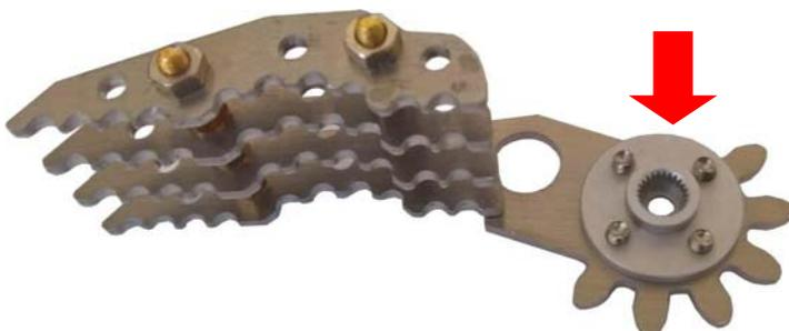
Die zweite Krallen wird angebracht und mit einer Schraube verschraubt.
