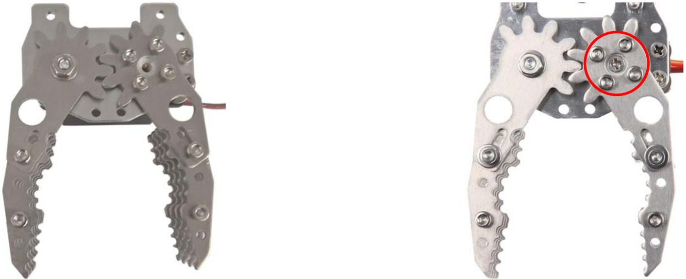
Jetzt wird ein Servohebel am Winkel befestigt. Dieser wird am Servo mit einer Schraube fixiert.
