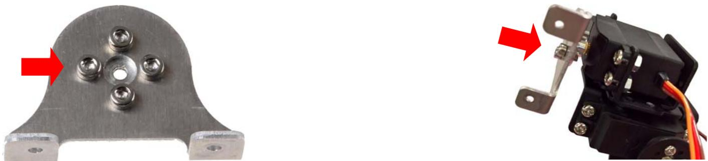
Als letzter Schritt wird die Krallen am Winkel verschraubt.
