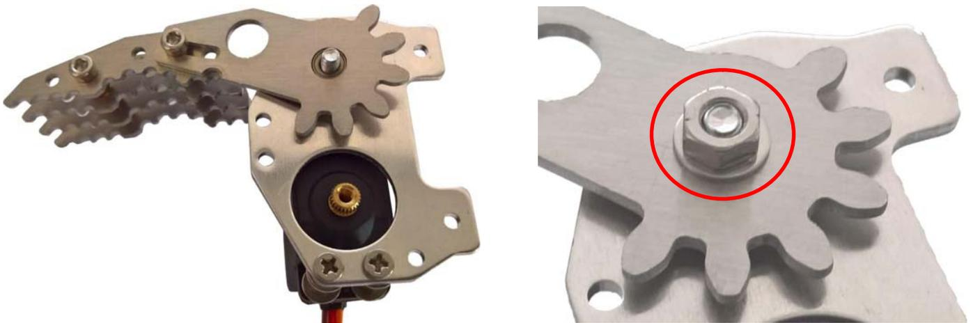
Bei der zweiten Kralle wird ein Servohebel mit 4 Schrauben angebracht.
