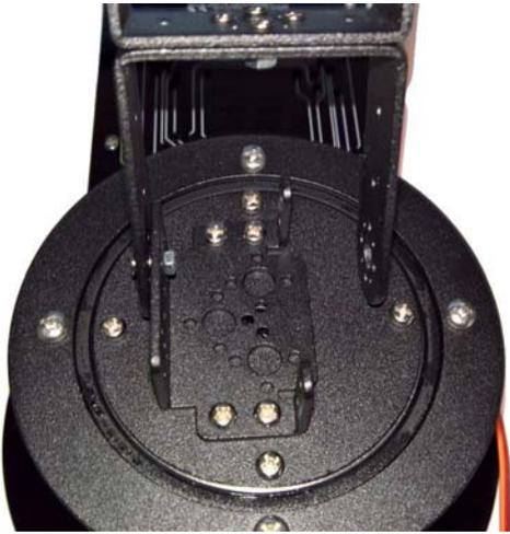
Als nächstes wird der Servo eingelegt und mit 4 Schrauben und Muttern befestigt.
