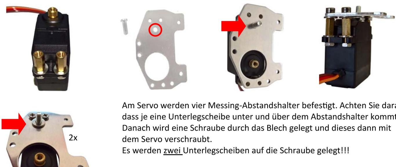
Am Servo werden vier Messing-Abstandshalter befestigt. Achten Sie darauf, dass je eine Unterlegscheibe unter und über dem Abstandshalter kommt. Danach wird eine Schraube durch das Blech gelegt und dieses dann mit dem Servo verschraubt.
