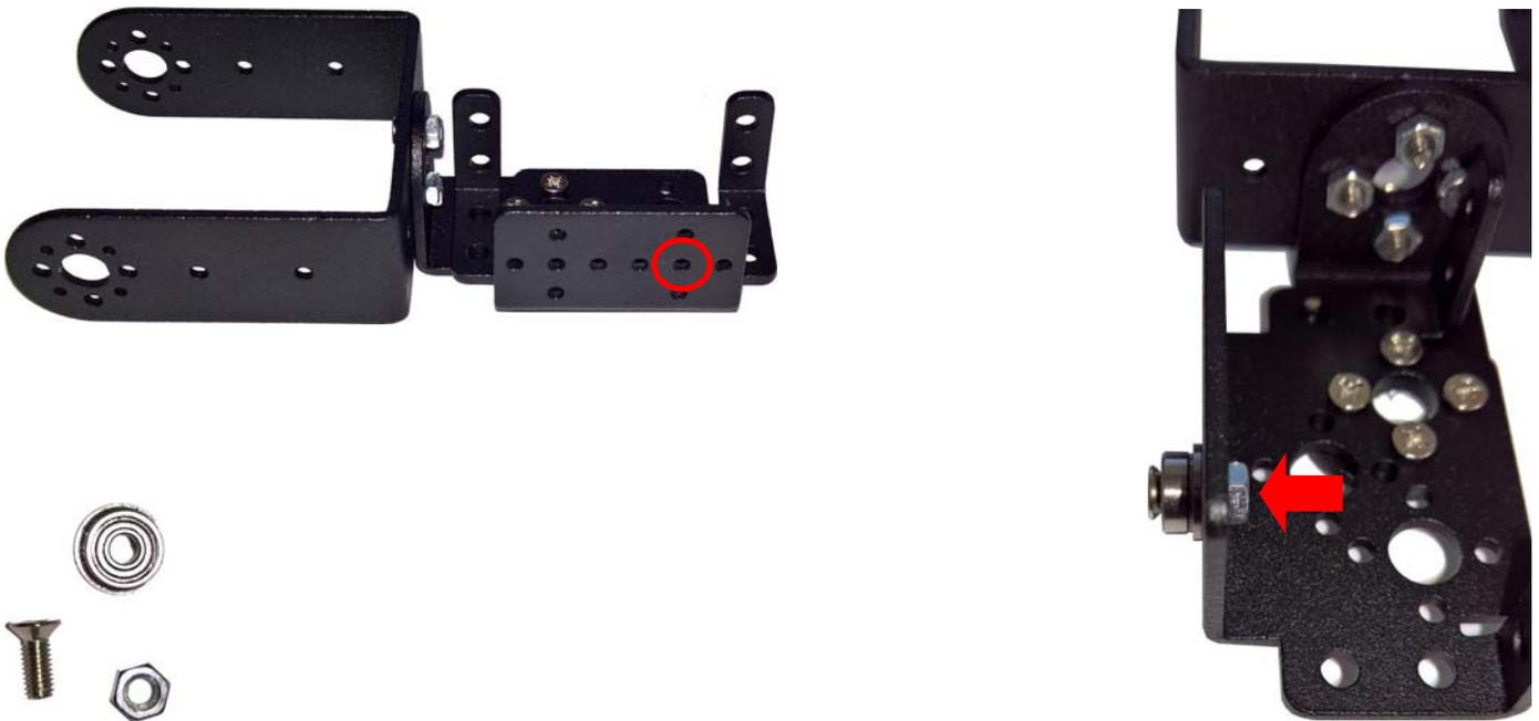
Der Servomotor wird eingelegt und mit vier Schrauben und Muttern befestigt. Danach wird es am Roboterarm auf beiden Seiten mit Schrauben angebracht.
