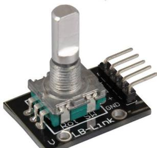
**KY-040** Kodierter Drehschalter (Rotary Encoder)
