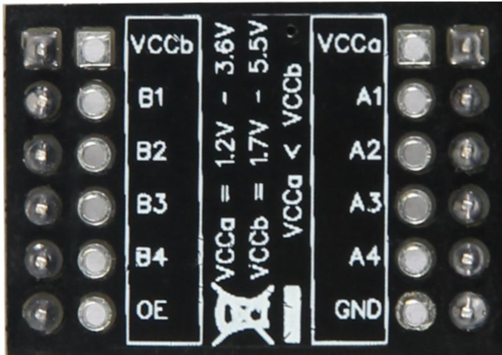
**Beispiel Anschluss-Belegung zwischen Arduino Raspberry Pi:**
