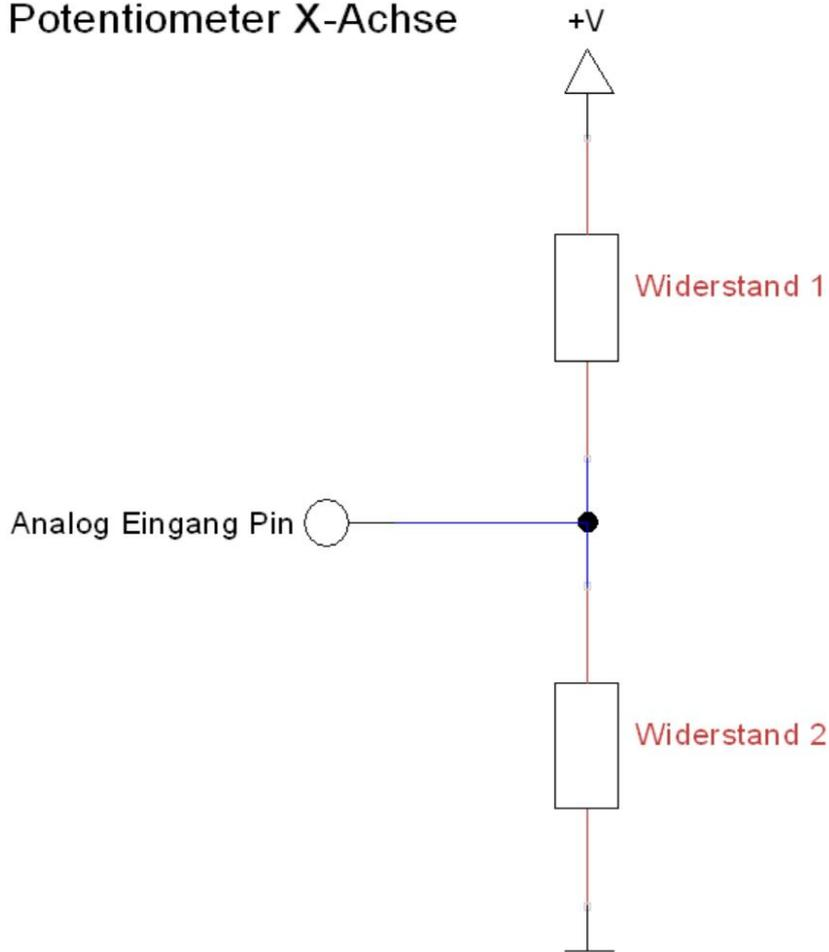
Im Ruhezustand befindet sich der Potentiometer in der Mitte, so dass Widerstand 1 und Widerstand 2 auch die angelegte Spannung gleichmäßig auf beide Widerstände verteilt - z.B. Messwert 0,5V.
