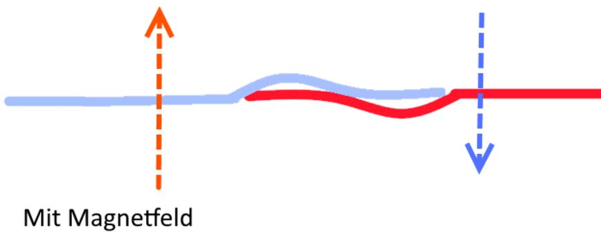
So wird ein elektrischer Kontakt geschlossen, welcher dann das Signal durchschaltet.
