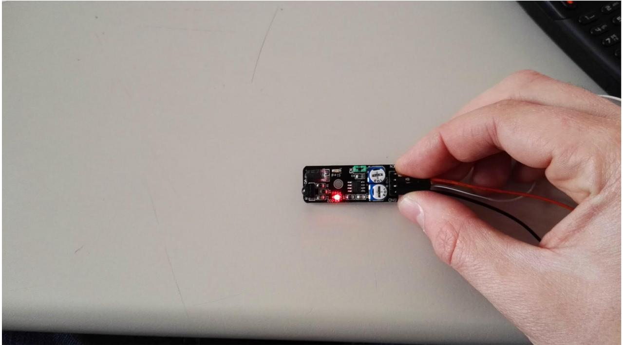
**Zustand 1:** Detektor hat Hindernis erkannt [LED auf dem Modul: Ein] [Sensor Signal= Digital Aus]
