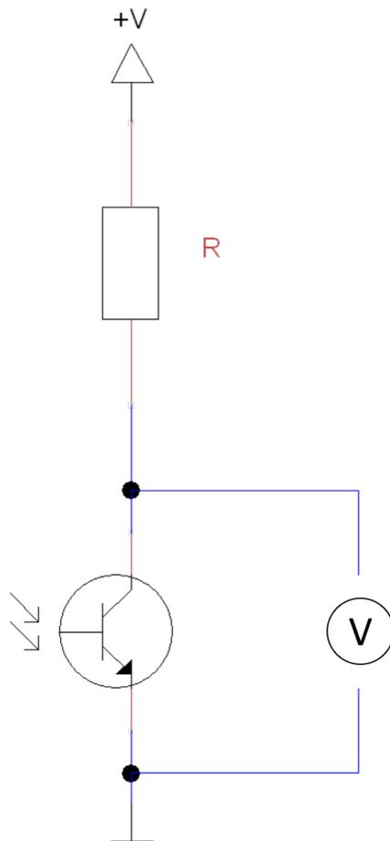
Schaltet man vor dem Transistor einen Widerstand in Reihe, so ergibt sich folgendes Verhalten, wenn die Spannung über den Transistor misst: Scheint den Transistor viel Licht bzw. ist es außen hell, so misst man eine niedrige Spannung nahe 0V gemessen über den Transistor im Dunklen, so lässt dieser einen kleinen Strom durch und man misst eine Spannung nahe +V.
