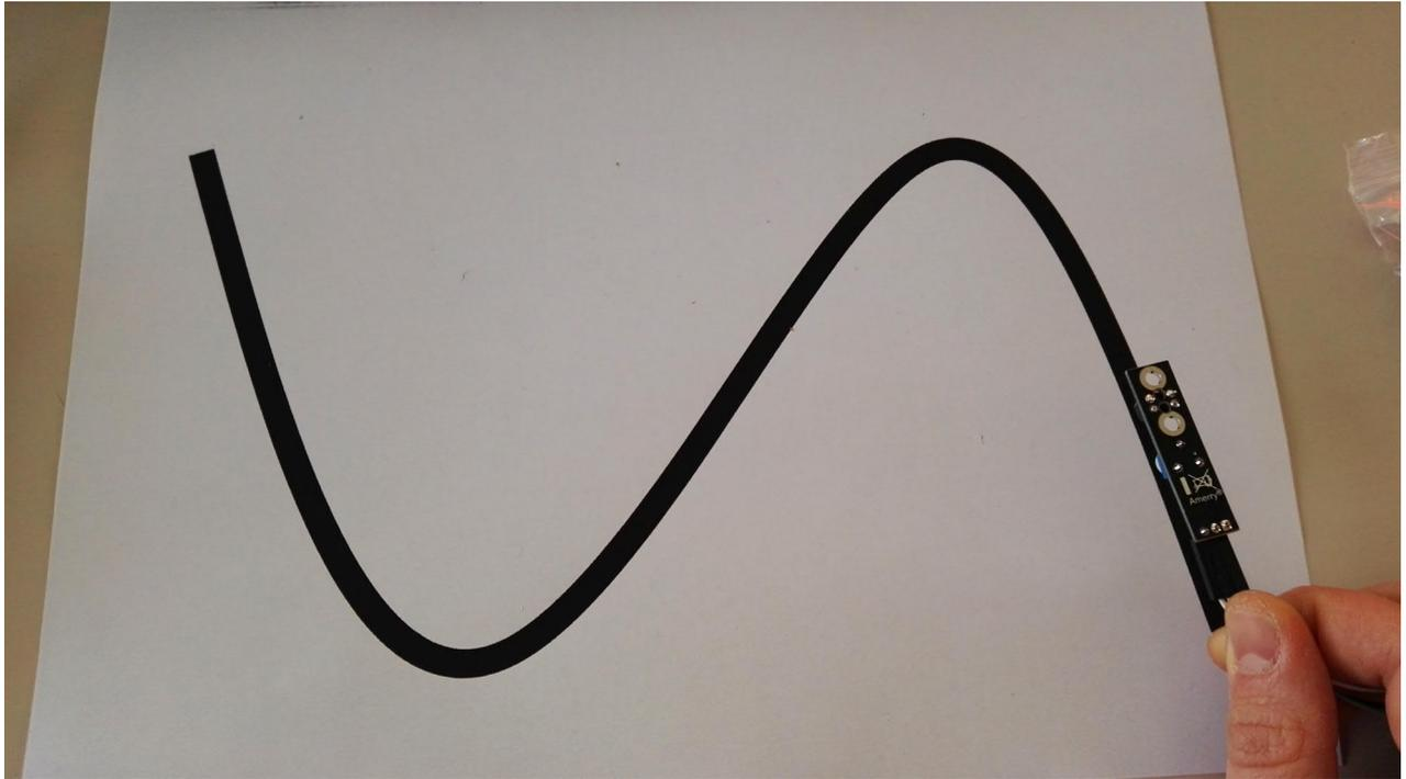
**Zustand 2:** Line Tracker ist außerhalb einer Line (reflektierenden Fläche) [LED auf dem Modul: AN] [Sensor Signal= Digital Aus]
