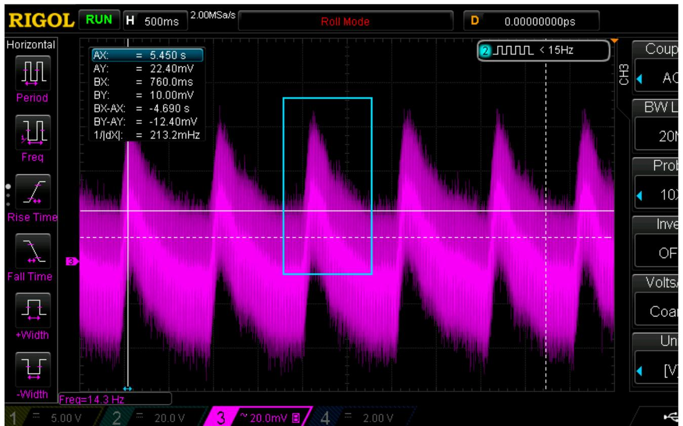
Dieses zeigt auf der Y-Achse die Veränderung der Spannung am Fototransistor - somit die Helligkeitsveränderungen hervorgerufen durch das fließende Blut. Die oben gekennzeichneten Spitzen ergeben somit das Schlagen vom Herz. Rechnet man nun die registrierten Schläge pro aufgenommener Zeit, so kommt man auf einen Puls von ca. 71 Schläge/Minute (bpm)
