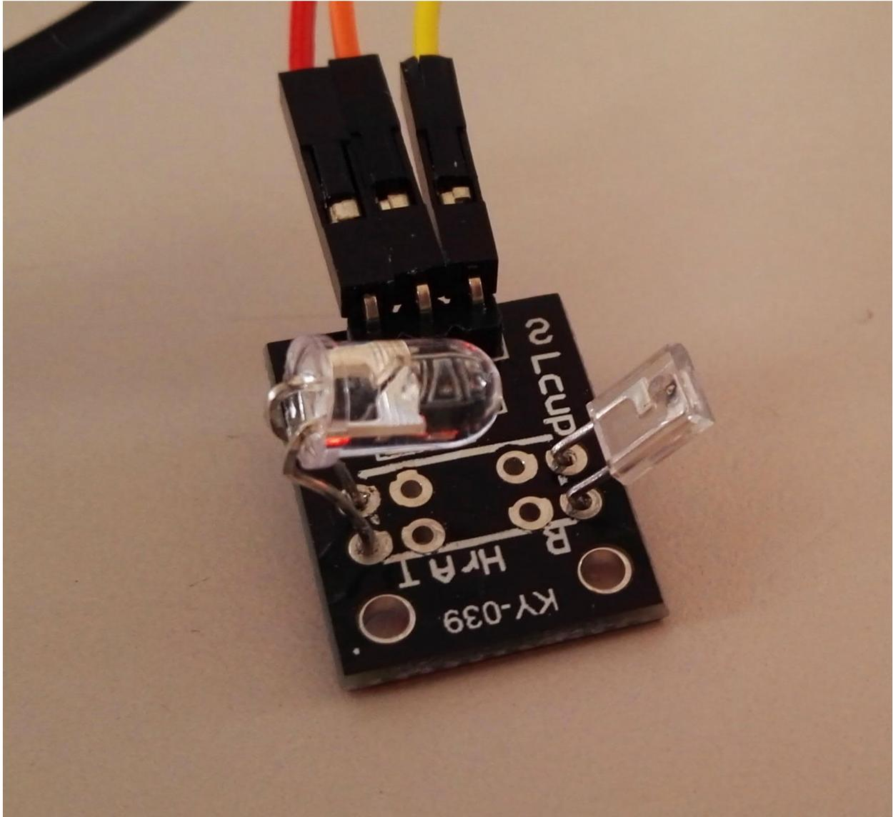
Zudem sollte beim messen am besten der kleine Finger verwendet werden, sowie darauf geachtet werden, dass zwischen Diode und Transistor kein blockierender Knochen sondern eher größtenteils die Haut aufgenommen wird.
