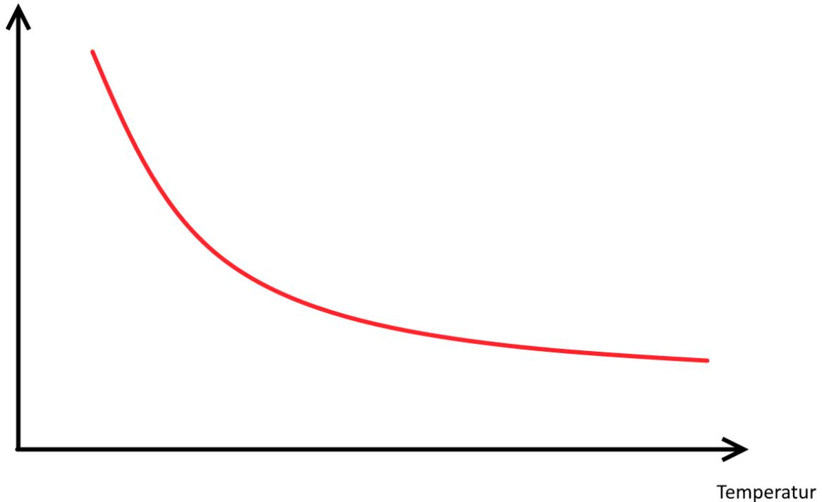
Diese Änderung des Widerstands lässt sich mathematisch annähern und in einen linearen Verlauf umrechnen und den Temperaturkoeffizienten (Abhängigkeit von Widerstandsänderung zur Temperaturänderung) bestimmen. Mittels diesen lässt sich somit dann immer die aktuelle Temperatur errechnen, wenn man den aktuellen Widerstand kennt.
