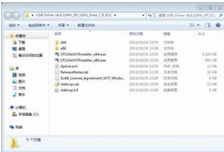
Entpacken und installieren Sie den Treiber Schritt für Schritt. Wählen Sie X86 für ein 32-Bit-Betriebssystem und X64 für ein 64-Bit-Betriebssystem aus.
