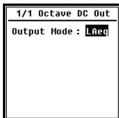
**1/1 Octave DC Out** (1/1-Oktaven-Gleichspannungsausgang) definiert das Ausgangssignal im 1/1-Oktav-Modus. Folgende Optionen sind verfügbar: LAeq, LBeq, LReq, LZeq, 31,5 Hz, 63 Hz, 125 Hz, 250 Hz, 500 Hz, 1 kHz, 2 kHz, 4 kHz, 8 kHz, 16 kHz. Drücken Sie zur Auswahl die Pfeiltasten <◀>, <▶>.
