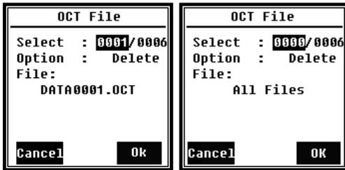
Im Menü **OCT File** (OCT-Datei) können Sie die OCT-Datei löschen. Die Bedienung erfolgt genauso wie im Menü für die **SWN-Datei**.
