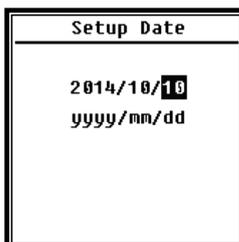
Mit den Pfeiltasten **<▲>**, **<▼>** können Sie das Datumformat auswählen und das Datum ändern. Mit den Pfeiltasten **<◀>**, **<▶>** können Sie das Jahr, den Monat und den Tag auswählen, und mit den Pfeiltasten **<▲>**, **<▼>** deren Wert modifizieren. Drücken Sie **<Eingabetaste>** um die Einstellung zu speichern.
