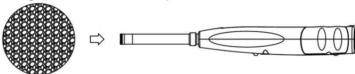
Drücken Sie den Windschutz entsprechend der oberen Abbildung fest bis zum Anschlag auf das Mikrofon. Weitere Details für Korrekturen des Windschutzes im Freien finden Sie in Anhang 4.
