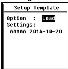
Drücken Sie die **<Eingabetaste>** bei leerer Vorlage. Die Vorlage kann eine Gruppeneinstellung speichern, für die der Benutzer eine Bezeichnung mit fünf Buchstaben oder Ziffern definieren kann.
