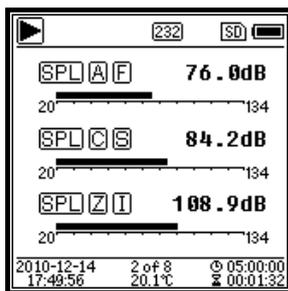
3 Profile Anzeige der Daten und des entsprechenden Messmodus des Filters und Detektors der Profilmessung gleichzeitig. Daten der 3 Profile können in einer SWN-Datei gespeichert werden.
