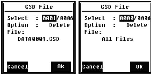
Im Menü **CSD File** (CSD-Datei) können Sie die CSD-Datei löschen, anzeigen und drucken. Mit den Pfeiltasten **<▲>**, **<▼>** können Sie den Cursor zwischen **Select** (Auswählen) und **Option** verschieben. Die Löschung erfolgt genauso wie im Menü der **SWN File** (SWN-Datei).
