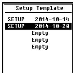
Mit der Setup-Vorlage speichern Sie fünf Benutzergruppen-Einstellungsparameter des Schallpegelmessgeräts für verschiedene Anwendungen.
