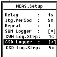
Zweck: Die Messung beginnt zuerst am 14. März 2015 00:00 Uhr und misst die ersten 5 min jeder Stunde. Die Messwerte werden bei Stopp der Messung in der CSD-Datei und jede Sekunde in der SWN-Datei gespeichert.
