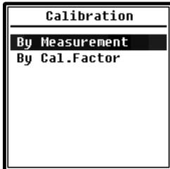
Wählen Sie die Option **Kalibrierung** aus und drücken Sie die <Eingabetaste>, um dieses Menü aufzurufen. Die Empfindlichkeit des Mikrofons wird durch zahlreiche Faktoren beeinflusst, beispielsweise Temperatur, Luftfeuchtigkeit und Luftdruck. Der Benutzer muss daher vor der Messung mindestens eine Kalibrierung durchführen.
