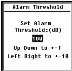
Wenn Messergebnisse des Profils 1 – 3 die **Alarmschwelle** übersteigen, leuchtet die LED über **<Power>** rot. Die Alarmschwelle kann zwischen 20 dB und 200 dB eingestellt werden. Mit den Pfeiltasten <▲>, <▼> können Sie die Alarmschwelle um 1 dB erhöhen oder reduzieren. Mit den Pfeiltasten <◀>, <▶> können Sie die Einstellung um 10 dB erhöhen oder reduzieren.
