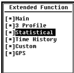
Mit der erweiterten Funktion können Sie einstellen, welcher Bildschirm angezeigt wird. Wenn der Bildschirm nicht ausgewählt ist, wird er nicht angezeigt. Beachten Sie, dass der Bildschirm für das **Hauptmenü** immer angezeigt wird.
