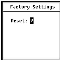
**Werkseinstellungen** bieten die Möglichkeit, alle Parameter, die von den Benutzern geändert wurden, auf die Werkseinstellungen zurückzusetzen. Die Parameter werden mit den Standardwerten initialisiert. Mit den Pfeiltasten **<◀>**, **<▶>** können Sie **Y** (Ja) oder **N** (Nein) auswählen. Wenn Sie **Y** (Ja) auswählen und die **<Eingabetaste>** drücken, wird der Parameter initialisiert. Wenn Sie **N** (Nein) auswählen oder die **ESC-Taste** drücken, wird der Reset abgebrochen.
