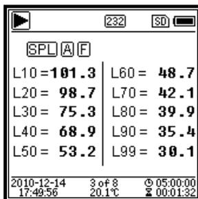
LN-Statistik Zeigt 10 Gruppen mit Statistikergebnissen an. Jede Datenquellengruppe (fester Modus für SPL, Filter und Detektor lassen sich anpassen) und der Prozentwert können im Menü eingestellt werden. Zeitverlauf Anzeige des aktuellen Rauschwerts und der Zeitdomänenkurve. Die Datenquellen (eines der 3 Profile) und die Zeitleiste (1 Minute, 2 Minuten und 10 Minuten) lassen sich anpassen.
