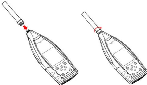
Schließen Sie das Mikrofon an den TNC-Verbinder an. Drehen Sie anschließend das Gewinde, bis die Teile fest verbunden sind.
