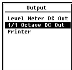
Für das Menü **Output** (Ausgang) können Sie auswählen, welche Messdaten am **Gleichspannungsausgang** ausgegeben werden sollen. Für den **Pegelmessgeräte-Modus** und **1/1-Oktave-Modus** gibt es die Optionen Pegelmessgerät-Gleichspannungsausgang und 1/1-Oktav-Gleichspannungsausgang.
