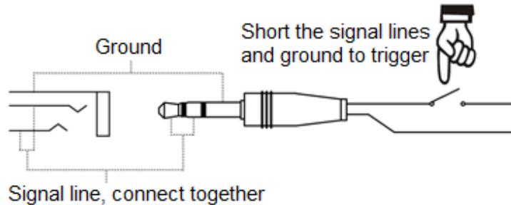
Die Messung wird durch eine Verbindung der Signalleitung mit Masse gestartet und durch deren Unterbrechung gestoppt. Beachten Sie, dass bei Aktivierung der **Trigger**-Funktion die **<Start/Stop>**-Schaltfläche nicht verfügbar ist.
