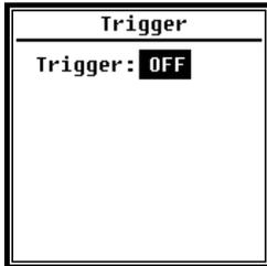
Im Menü **Trigger** können Sie die Funktion des Triggers ein- und ausschalten. Der **Trigger** ist ein Analogeingang mit dem Sie per Fernsteuerung die Messung für das Schalldruck-Messgerät starten oder stoppen können. Der Triggereingang befindet sich an der Unterseite des Schalldruck-Messgeräts (Kopfhörerbuchse 3,5 mm).
