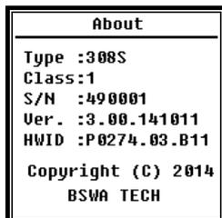
Das Menü "About" (Über) zeigt Typ, Klasse und Seriennummer, Version sowie HWID (Hardware-ID) des Schallpegelmessgeräts an.
