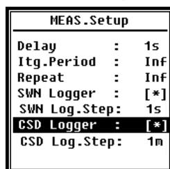
Das Menü **MEAS.Setup** (Mess-Setup) ist das wichtigste Menü für die Messung. Hier können Sie die Parameter für die **Verzögerung**, den **Integrationszeitraum**, die **Wiederholung**, den **SW-Protokollschritt**, den **SWN-Protokollschritt**, das **CSD-Protokoll** und den **CSD-Protokollschritt** einstellen. Optionen können Sie mit den Pfeiltasten **<▲>**, **<▼>** auswählen.
