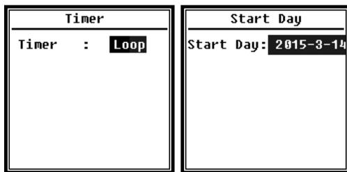
Stellen Sie den **Timer** auf **Schleifenmodus** ein, damit die Messung immer wieder neu ausgelöst wird.
