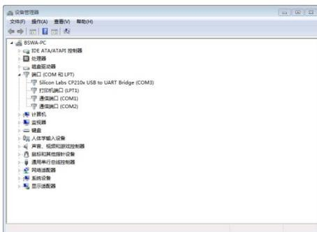
Verbinden Sie nach der Treiberinstallation das Schallpegelmessgerät über ein USB-Kabel mit dem Computer. Im Gerätemanager finden Sie ein neues Gerät mit der Bezeichnung **Silicon Labs CP210x USB to UART Bridge (COMx)**.
