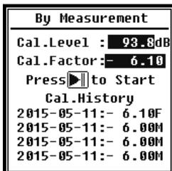
Wählen Sie die Option **By Measure** (Durch Messung) aus und drücken Sie die <Eingabetaste>, um dieses Menü aufzurufen. Weitere Details zu dem angegebenen Kalibrator und dem entsprechenden Anpasswert finden Sie in Anhang 2, Anpassung der Kalibrierprüffrequenz.
