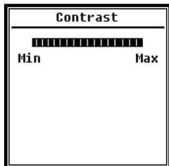
Im Menü **Contrast** (Kontrast) können Sie den Kontrast der LCD-Anzeige in 14 Stufen einstellen. Drücken Sie zur Auswahl die Pfeiltasten **<▲>**, **<▼>**.
