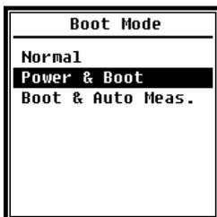
Im **Start-Modus** wählen Sie mit den Pfeiltasten **<▲>**, **<▼>** den Modus **Normal**, **Power & Boot** (Einschalten und Starten) sowie **Boot & Auto Meas.** (Einschalten und Automatische Messung) aus.
