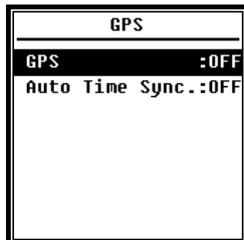
Im Menü **GPS** können Sie die Optionen **GPS** und **Auto Time Sync** (Automatische Zeitsynchronisation) aktivieren oder deaktivieren. Wenn das **GPS** deaktiviert ist, wird das interne GPS-Modul abgeschaltet. Die Systemuhr des Schallpegelmessgeräts synchronisiert sich mit der GPS-Zeit, wenn Sie die Option **Auto Time Sync** (Automatische Zeitsynchronisation) aktivieren.
