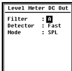
Der **Gleichspannungsausgang** des Pegelmessgeräts kann den Signalausgang für den Pegelmessgerätemodus einstellen. Drücken Sie zur Auswahl die Pfeiltasten <▲>, <▼>, <◀>, <▶>.
