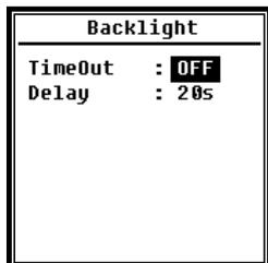
Das Schalldruck-Messgerät schaltet die Hinterleuchtung automatisch ab, um den Stromverbrauch zu reduzieren und die Batterie zu schonen.
