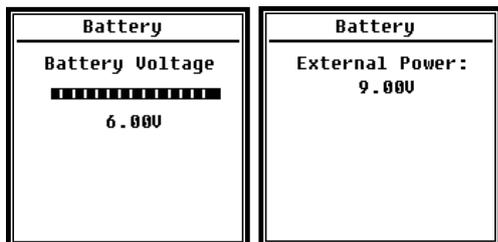
Das Menü **Battery** (Batterie) zeigt den Zustand und die Spannung der Batterie an.
