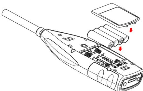
Wechseln Sie die Batterien und verschließen und verriegeln Sie das Batteriefach wieder.
