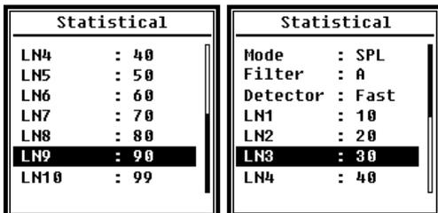
Die Datenquelle für die Statistik ist fest auf SPL eingestellt. Der Benutzer kann diese Einstellung nicht ändern. Der Benutzer kann jedoch den Filter und Detektor für SPL sowie den Statistikwert über dieses Menü definieren.
