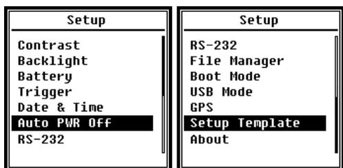
Das **Setup**-Menü enthält die Basisfunktion Setup und Bedingungsanzeige. Mit den Pfeiltasten **<▲>**, **<▼>** können Sie die Option auswählen und mit der **<Eingabetaste>** die nächste Menüebene aufrufen.
