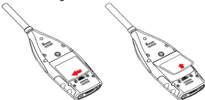
Drehen Sie den Verschluss nach links, um den Batteriedeckel abzunehmen. Heben Sie den Batteriedeckel ab.
