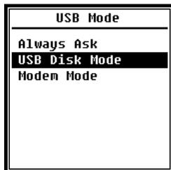
Im Menü **USB Mode** (USB-Modus) können Sie den Arbeitsmodus einstellen, wenn Sie das Schallpegelmessgerät über ein USB-Kabel mit dem Computer verbinden. **Always Ask** (Immer fragen), **USB Disk Mode** (USB-Laufwerk) und **Modem Mode** (Modem-Modus) stehen als Auswahl zur Verfügung.
