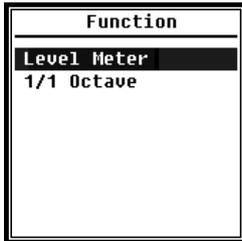
Wählen Sie die **Funktion** aus und drücken Sie die <Eingabetaste>, um dieses Menü aufzurufen. Sie können 2 Messarten auswählen: **Pegelmessung** und **1/1 Oktavmessung**. Drücken Sie die Pfeiltasten <▲>, <▼>, um den Messmodus auszuwählen. Drücken Sie die <Eingabetaste>, um die Einstellung zu speichern und zum vorherigen Menü zurückzukehren. Drücken Sie die Taste <ESC>, um zum vorherigen Menü zurückzukehren.
