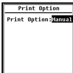
Mit der Option **Print** (Drucken) können Sie den Drucker auf automatischen oder manuellen Ausdruck einstellen. Wenn Sie die Option **Auto** auswählen, werden Messergebnisse nach dem Stopp der Messung automatisch ausgedruckt.
