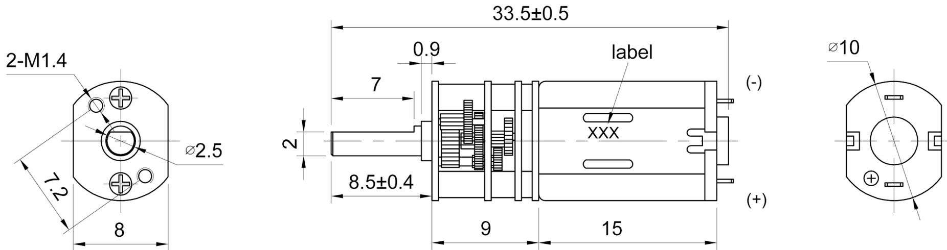
Dank minimalen Abmessungen und einer Übersetzung von 1:250 bietet sich dieses neue Mikrogetriebe für unterschiedlichste Anwendungen an. Ob als Radarantrieb in Schiffen, als Fahrtrieb für kleine Maßstäbe, Winden, usw. Überall dort wo Bewegung auf engstem Raum gefordert wird, kommt das G250 zum Einsatz.
