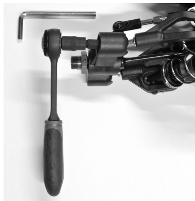
Serrez/desserrez la vis sans tête (C)
