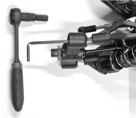
Kugelkopfschraube (A und B) einstellen
