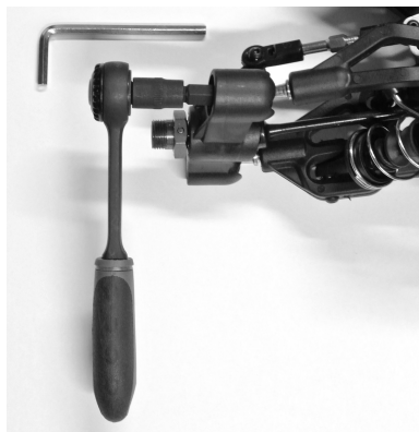
Stelschroef (C) los-/vastdraaien
