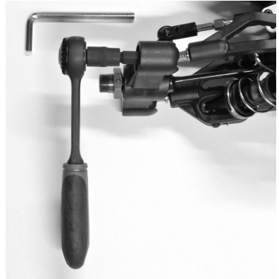
Madenschraube (C) festdrehen/lösen
