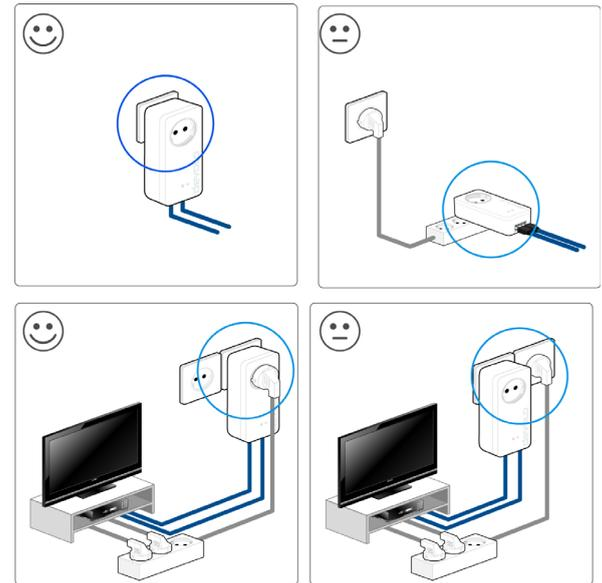
Abb. 5 dLAN-Bandbreitenoptimierung
