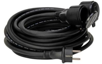
Gummi-Verlängerung, IP44, 16A, 250V~, Schutzkontakt- Gummi-Stecker und 2-fach Schutzkontakt-Gummi-Kupplung mit Gummi-Leitung H07RN-F 3x1,5mm<sup>2</sup>, 10 Meter, schwarz
