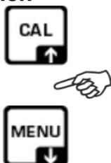
Mit den Navigationstasten  $\updownarrow$  lassen sich die einzelnen Menüpunkte der Reihe nach anwählen. Der Cursor (▶) links neben dem Text zeigt den aktiven Menüpunkt an.
