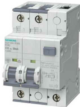
FI/LS-Schalter, 10 kA, 2P, Typ A, 30 mA, C-Char, In: 10 A, Un AC: 230 V
