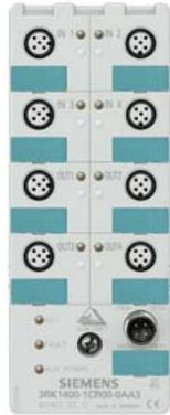
AS-i Kompaktmodul K60 digital 4DI/4DQ, IP68 4 x Eingang, maximal 200 mA 4 x Ausgang, 2 A, DC 24 V maximal 4 A für alle Ausgänge 8 x M12-Buchse Montageplatte 3RK1901-0CA00 ist separat zu bestellen
