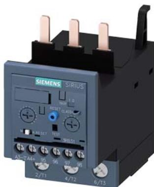
Überlastrelais 20...80 A elektronisch für Motorschutz Baugröße S2, CLASS 5E...30E Schützenbau Hauptstromkreis: Schraub Hilfsstromkreis: Schraub Hand-Automatik-RESET interne Erdschlusserkennung
