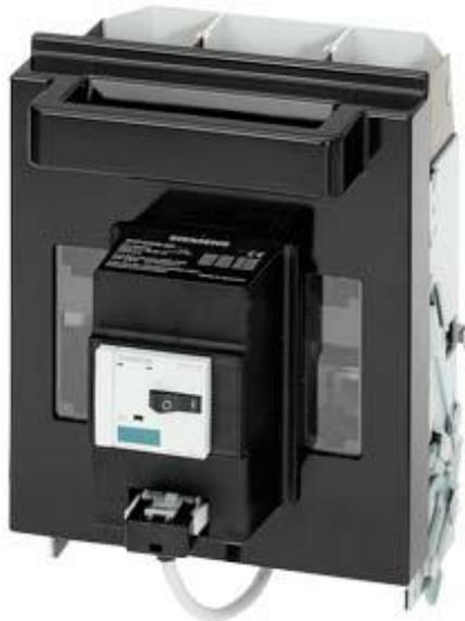
SETRON, Sicherungslasttrennschalter 3NP5, 3-polig, NH1, 250 A, für Aufbau und Einbau auf Montageplatte, mit Schnelleinschaltung, Schraubanschluss, Sicherungsüberwachung: durch 3RV, Hilfsschalter am Lasttrennschalter: 1S+1Ö, Hilfsschalter an der Sicherungsüberwachung: 1S+1Ö
