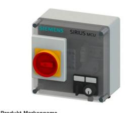
SIRIUS MCU Motorstarter Gehäuse Schutzart IP55 Kunststoff Kommunikation ohne elektromechanisch schaltend Kurzschlussschutz mit Leistungsschalter Wendestarter Bremse ohne Leistungsklasse 4 A Motorschutzleistungsschalter mit Bi-Metall thermisch Handbedienung rastend Anschluss Power M-Verschraubung EGH Ausführung
