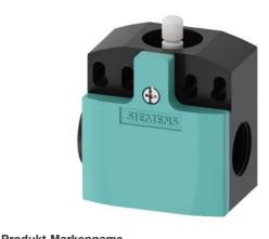
Positionsschalter mit erhöhtem Korrosionsschutz Kunststoffgehäuse 50mm, Geräteanschluss 2 x (M20 x 1,5) 1S/1Ö integrierte (nicht austauschbare) Sprungkontakte, Kuppenstößel
