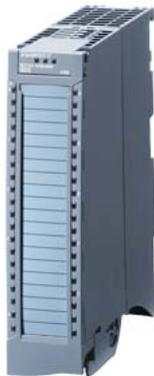
SIMATIC S7-1500, Analogeingabemodul AI 8xU/I/RTD/TC ST, 16 Bit Auflösung, Genauigkeit 0,3%, 8 Kanäle in Gruppen zu 8, 4 Kanäle bei RTD Messung, Gleichtaktspannung 10V; Diagnose; Prozessalarme; Lieferung inklusive Einspeiseelement, Schirmbügel und Schirmklemme: Frontstecker (Schraubklemmen oder Push-In) separat bestellen
