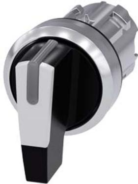
Knebelschalter, beleuchtbar, 22 mm, rund, Metall, hochglanz, weiß, Knebel, lang, 3 Schaltstellungen I>O-II, links tastend, rechts verrastend, Schaltwinkel 2x45°, 10:30h/12h/13:30h
