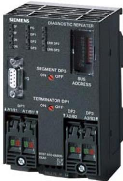
SIMATIC S7, Diagnose-Repeater für PROFIBUS-DP, zur online- Diagnose der PROFIBUS-Leitung, DP-Norm-Slave bis 12 MBit/s, Schutzart IP20, fast-connect- Anschlussstechnik
