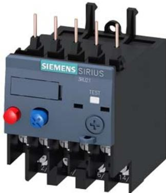
Überlastrelais 7,0...10 A thermisch für Motorschutz Baugröße S00, CLASS 10 Schützenbau Hauptstromkreis: Ringkabelschuh
