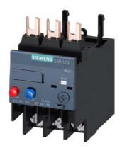
Überlastrelais 14...20 A thermisch für Motorschutz Baugröße S0, CLASS 10 Schützanbau Hauptstromkreis: Ringkabelschuh Hilfsstromkreis:Ringkabelschuh Hand-Automatik-RESET
