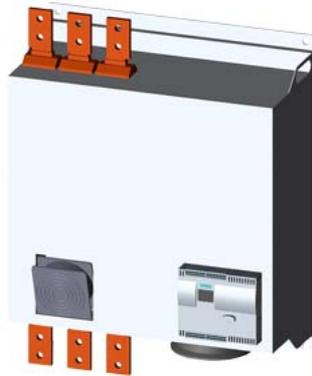
SIRIUS Sanftstarter Werte bei 400 V, 40 °C Standard: 1076 A, 630 kW Wurzel-3: 1864 A, 1100 kW AC 200-460 V, AC 230 V Federzugklemmen !!! Auslaufprodukt !!! Nachfolger ist SIRIUS 3RW5, Präferierte Nachfolgertypen sind >>3RW5558-2HA14<<
