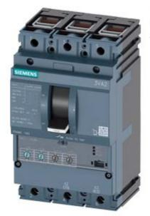
Leistungsschalter 3VA2 IEC Frame 160 Schaltvermögenklasse H Icu=85kA @ 415V 3-polig, Anlagenschutz ETU350, LSI, In=100A Überlastschutz Ir=40A...100A Kurzschlussschutz Isd=1,5...10 x Ir, Ii=12 x In Klemmenanschluss Spannungsauslöser (STL) 110-127V DC, AC 50/60Hz 2 Hilfsschalter HQ 1 Ausgelöst-Meldeschalter HQ 1 Schutzauslöser-Meldeschalter
