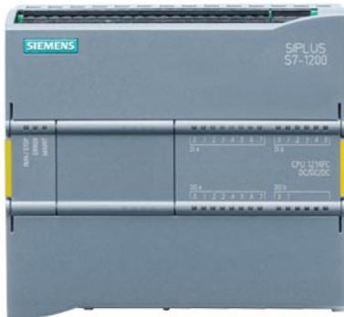
SIPLUS S7-1200 CPU 1214FC DC/DC/DC based on 6ES7214-1AF40-0XB0 mit Conformal Coating, -25...+55°C, Kompakt-CPU, DC/DC/DC, onboard I/O: 14 DI DC 24V; 10 DO 24V DC; 2 AI 0-10V DC, Stromversorgung: DC 20,4-28,8V DC, Programm-/Datenspeicher 125 KB
