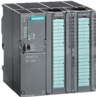
SIMATIC S7-300, CPU 314C-2 DP Kompakt-CPU mit MPI, 24 DE/16 DA, 4AE, 2AA, 1 Pt100, 4 schnelle Zähler (60 kHz), integrierte DP-Schnittstelle, integr. Stromversorgung DC 24V, Arbeitsspeicher 192 kByte, Frontstecker (2x 40-polig) und Micro Memory Card erforderlich
