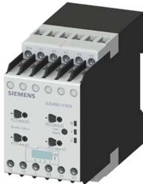
Isolationsüberwachungsrelais für ungeerdete (IT-) Netze bis 400 V AC, 15-400 Hz und bis 600 V DC Messbereich 1-100 / 2-200 kOhm
