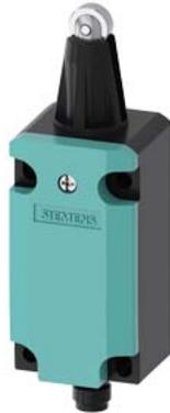
Positionsschalter mit Rollenstößel Metallgehäuse 40 mm nach DIN EN 50041, 1S/1Ö Sprungschaltglied mit M12-Stecker, 5-polig, fest, mit 2 LED, gelb/grün, DC 24 V, 4 A, Pin-Belegung: Pin1=21+13 Brücke + LED grün, Pin2=22, Pin3=Masse LED, Pin4=14 + LED gelb, Pin5=PE
