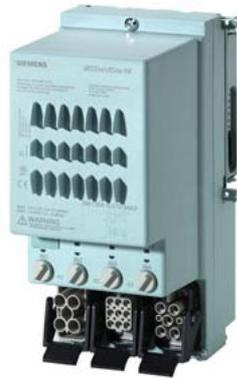
ET 200pro ERSE/RSSE HF elektronischer Reversierstarter elektronisch (Sanft-) schaltend Motorvollschutz bestehend aus: elektronischer Überlastschutz + Thermistor 3 AC 400 V/0,9kW 0,15 A...2,00 A ohne Bremskontakt 4DI Han Q4/2 - Han Q8/0
