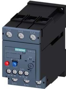
Überlastrelais 54...65 A thermisch für Motorschutz Baugröße S2, CLASS 10 Einzelaufstellung Hauptstromkreis: Schraub Hilfsstromkreis: Schraub Hand-Automatik-RESET
