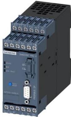
Grundgerät SIMOCODE pro V PB, PROFIBUS DP-Schnittstelle 12 MBit/s, RS-485, 4E/3A frei parametrierbar, US: 110...240 V AC/DC, Eingang für Thermistoranschluss monostabile Relais-Ausgänge, erweiterbar durch Erweiterungsmodule
