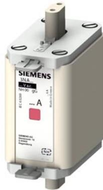
NH-Sicherungseinsatz, NH00, In: 125 A, gG, Un AC: 500 V, Un DC: 250 V, Kombikennmelder, isolierte Griffflaschen
