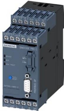
Grundgerät SIMOCODE pro C, PROFIBUS DP-Schnittstelle 12 MBit/s, RS-485, 4E/3A frei parametrierbar, US: 24 V DC, Eingang für Thermistoranschluss monostabile Relais-Ausgänge
