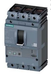
Leistungsschalter 3VA2 IEC Frame 160 Schaltvermögenklasse M Icu=55kA @ 415V 3-polig, Motorschutz ETU350M, LSI, In=100A Überlastschutz Ir=40A...100A Kurzschlussschutz Isd=3...15 x Ir, Ii=15 x In Klemmenanschluss Unterspannungsauslöser (UVR) 120-127V AC 50/60Hz 2 Hilfsschalter HQ 1 Ausgelöst-Meldeschalter HQ
