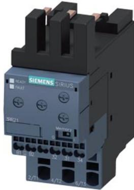
Überwachungsrelais, anbaubar an Schütz 3RT2, Baugröße S0 Basic, analog einstellbar Scheinstromüberwachung 4...40 A, 50...60 Hz, 2-phasig Versorgung 24 V AC/DC 1 Wechsler Überwachung auf Stromüber- und Unterschreitung Phasenausfall, Drahtbruch mit oder ohne Fehlerspeicher Anlaufverzögerung 0-60 s Störspitzenausblendung 0-30 s Schalthysterese 6% Federzugtechnik
