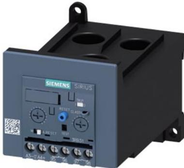
Überlastrelais 12,5...50 A elektronisch für Motorschutz Baugröße S3, CLASS 5E...30E Einzelaufstellung Hauptstromkreis: Durchsteckkw. Hilfsstromkreis: Schraub Hand-Automatik-RESET
