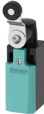
Positionsschalter Kunststoffgehäuse nach DIN EN 50047, 31 mm Geräteanschluss 1 x (M20 x 1,5) 1S/1Ö Sprungkontakte integriert (nicht austauschbar) Schwenkhebel, 35 mm lang rechts/links einstellbar mit Kunststoffrolle 19 mm
