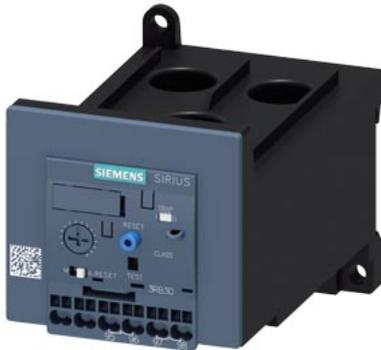
Überlastrelais 12,5...50 A elektronisch für Motorschutz Baugröße S3, CLASS 10E Einzelaufstellung Hauptstromkreis: Durchsteckw. Hilfsstromkreis: Federzugklemme Hand-Automatik-RESET
