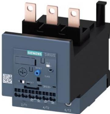
Überlastrelais 32...115 A elektronisch für Motorschutz Baugröße S3, CLASS 20E Schützenbau Hauptstromkreis: Schraub Hilfsstromkreis: Federzugklemme Hand-Automatik-RESET
