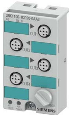
AS-i Kompaktmodul K45 digital 4DQ, IP67 4 x Ausgang, 1 A DC 24 V maximal 3 A für alle Ausgänge 4 x M12 Buchse Montageplatte 3RK1901-2EA00 oder 3RK1901-2DA00 ist separat zu bestellen
