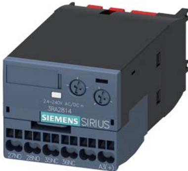
Elektronisch zeitverzögerter Hilfsschalter rückfallverzögert mit Steuersignal Relais 1 Ö + 1 S AC/DC 24...240 V Zeitbereich 0,05...100 s frontseitig aufschraubbar für Schütze 3RT2 S00-S3 und Hilfsschütze 3RH2 S00 Federzuganschluss Varistor zur Bedämpfung der Schützpulen integriert
