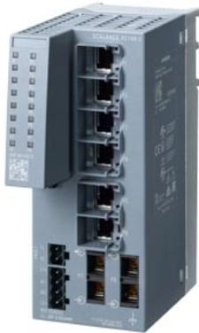
SCALANCE XC106-2, unmanaged IE Switch, 6x 10/100 Mbit/s RJ45 Ports, 2x 100 Mbit/s Multimode SC, LED-Diagnose, Fehlermelde- Kontakt mit Set-Taster, redundante Spannungsversorgung Handbuch als Download verfügbar .
