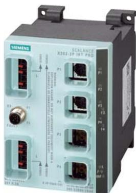
SCALANCE X202-2PIRT PRO, managed IE IRT Switch, Schutzart IP65/67, 2x 10/100 Mbit/s Push Pull RJ45 Ports, 2x 100 Mbit/s Push Pull SCRJ Port; Fehlermeldekontakt mit Set- Taster, redundante Spannungs- Versorgung, PROFINET IO Device; Netzwerk-Management, Redundanz-Manager integriert, inkl. elektron. Handbuch auf CD-ROM, C-PLUG optional.
