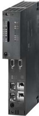
SIMATIC S7-400H, CPU 414-5H, Zentralbaugruppe für S7-400H und S7-400F/FH, 5 Schnittstellen: 1x MPI/DP, 1x DP, 1x PN und 2 für Sync-Module, 4 MB Speicher (2 MB Daten/2 MB Programm)
