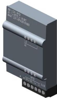
SIPLUS S7-1200 SB 1231 1AI RTD based on 6ES7231-5PA30-0XB0 mit Conformal Coating, -40...+60°C, start up -25°C, SIPLUS S7-1200, Analogeingabe, SB 1231RTD, 1 AI RTD, PT 100 und PT1000
