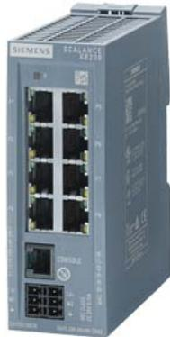
SCALANCE XB208 managebarer Layer 2 IE Switch 8x 10/100 Mbit/s RJ45 Ports 1x Konsolen-Port ; Diagnose-LED redundante Spannungsversorgung IEC 62443-4-2 zertifiziert; Temp.-Bereich 0°C bis +60°C; Hutschienenmontage; Default PROFINET.
