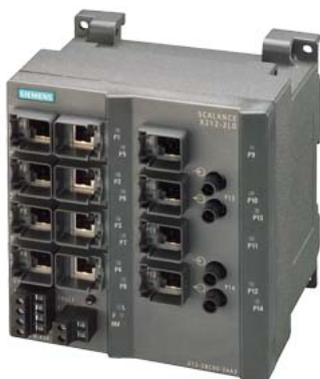
\*\*\*\*\* Ersatzteil \*\*\*\*\* SCALANCE X212-2LD, managed IE Switch, 12x 10/100 Mbit/s RJ45 Ports, 2x 100 Mbit/s Single-Mode BFOC, LED-Diagnose, Fehlermelde-Kontakt mit Set-Taster, redundante Spannungsversorgung, PROFINET IO Device, Netzwerk-Management, Redundanz-Manager integriert, inkl. elektron. Handbuch auf CD-ROM, C-PLUG optional.
