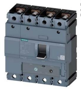
Leistungsschalter 3VA1 IEC Frame 250 Schaltvermögenklasse H Icu=70kA @ 415V 4-polig, Anlagenschutz TM240, ATAM, In=250A Überlastschutz Ir=175A...250A Kurzschlussschutz Ii=5...10 x In N-Leiter ungeschützt Schraubenflachanschluss Spannungsauslöser (STL) 110-127V DC, AC 50/60Hz 2 Hilfsschalter HQ 1 Ausgelöst-Meldeschalter HQ
