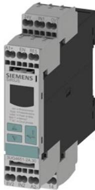
Digitales Überwachungsrelais Drehzahlüberwachung von 0.1 bis 2200 U/min Über- und Unterschreitung AC/DC 24 bis 240 V DC und AC 50 bis 60 Hz Anlaufverzögerung 1 bis 900 s Auslöseverzögerung 0,1 bis 99,9 s Hysterese 0.1 bis 99 U/min 1 Wechsler mit oder ohne Fehlerspeicher Federzugtechnik
